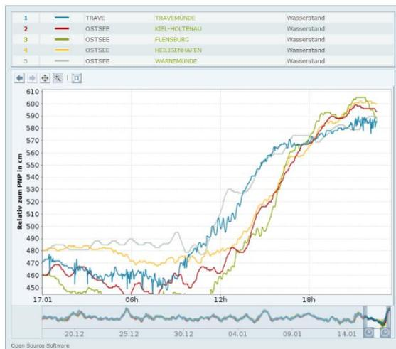
Abbildung 3 Verlauf des Wasserstands an verschiedenen Pegeln im Bereich der Kieler und Lübecker Bucht. (Quelle Pegelonline)
