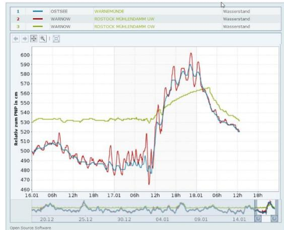
Abbildung 2 Pegelkurven bei Rostock. Mühlendamm OW ist durch eine Schleuse von der eigentlichen Ostsee getrennt. Mühlendamm UW zeigt Eigenschwingungen der Warnow, die in geringerem Maße auch am Pegel Warnemünde sichtbar sind. (Quelle Pegelonline)
