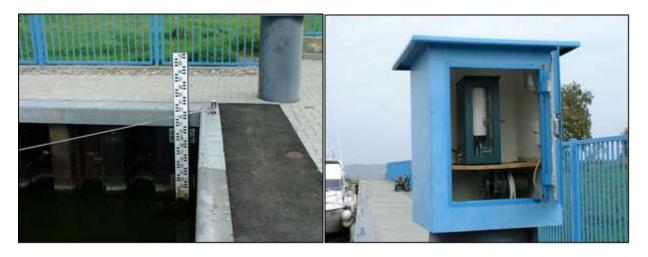
Der Wasserstand kann direkt an der Pegellatte abgelesen werden. Die Datenerfassung erfolgt mittels Schwimmerpegel und/oder Drucksonden. Das rechte Bild zeigt die Schreibpegelaufzeichnung des gedämpften Wasserstandes.
