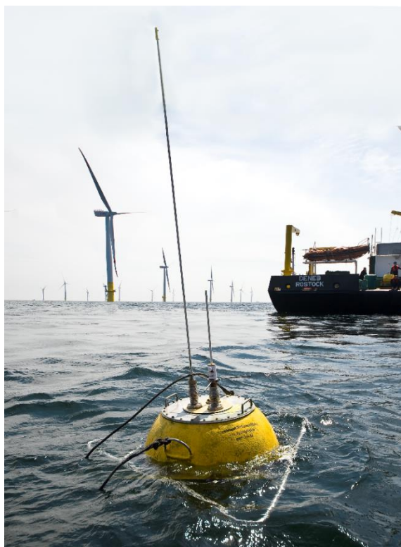
Abbildung 19: "Wave-Rider" zur Messung des Tiefwasserseegegangs
