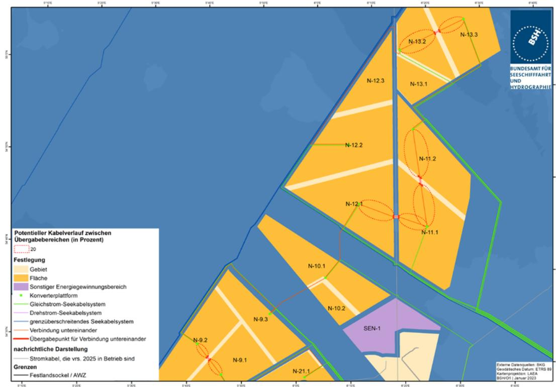
Abbildung 10: Festlegungen für Verbindungen zwischen Anlagen untereinander: Illustration möglicher Trassenlängen für Verbindungen untereinander in Form von Ellipsen
