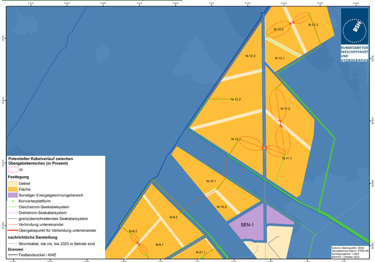
Abbildung 11: Festlegungen für Verbindungen zwischen Anlagen untereinander: Illustration möglicher Trassenlängen für Verbindungen untereinander in Form von Ellipsen
