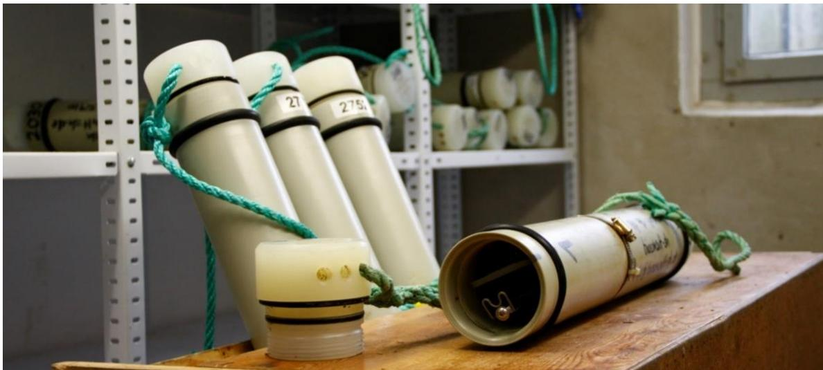
Abb. 2.13 C-PODs bereit für die Ausbringung (links) und ein geöffneter C-POD (rechts).
