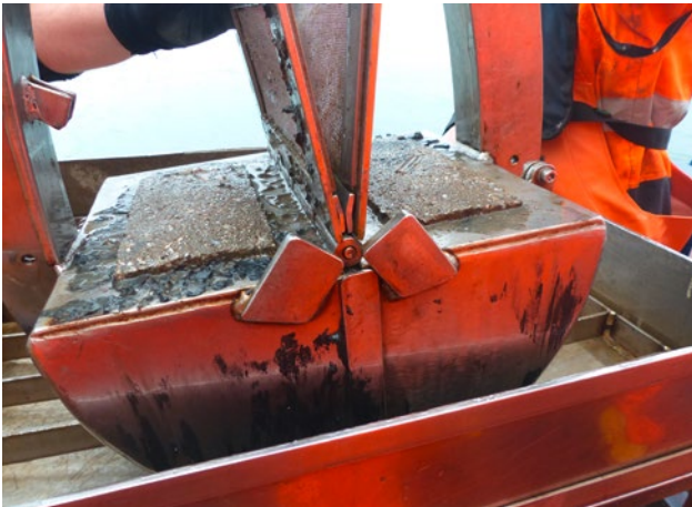
Standard-Fanggerät für die Erfassung der wirbellosen Infauna nach StUK4: Van-Veen-Greifer mit Inhalt, unmittelbar vor der Siebung der Probe (Foto: Dr. Andreas Dänhardt, BSH)
