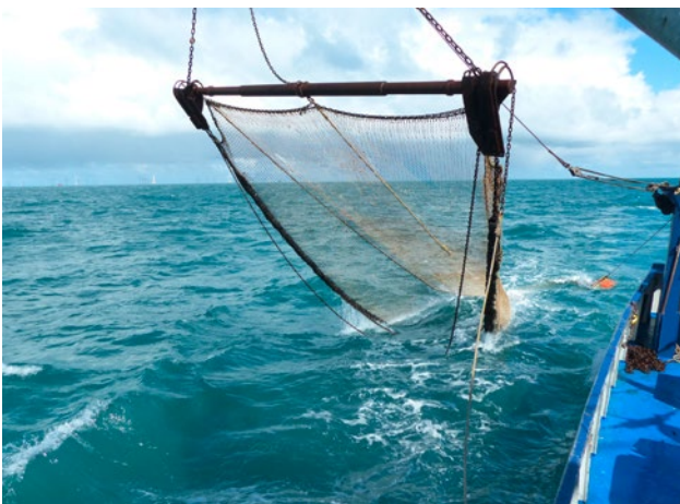
Standard-Fanggerät für die Fischerfassung nach StUK4: 7-m-Baumkurre am Steuerbordausleger eines für die Voruntersuchung des Schutzgutes Fische gecharterten Krabbenkutters (Foto: Dr. Andreas Dänhardt, BSH)
