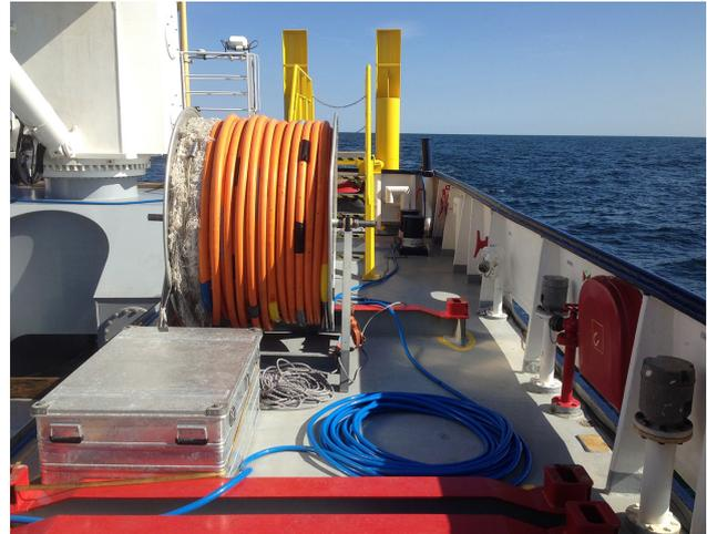
Blick über das Arbeitsdeck der LEV TORNADO nach Achtern auf die mehrkanalseismische Streamerwinde. (Foto: Florian Meier, Fraunhofer IWES)
