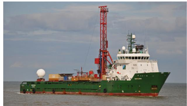
Bohrschiff GARGANO. (Foto: Fugro)
