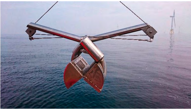
Abbildung 18: Standard-Erfassungsgerät für die Infauna nach StUK4: van Veen-Greifer (Foto: Sebastian Fuhrmann, BSH)
