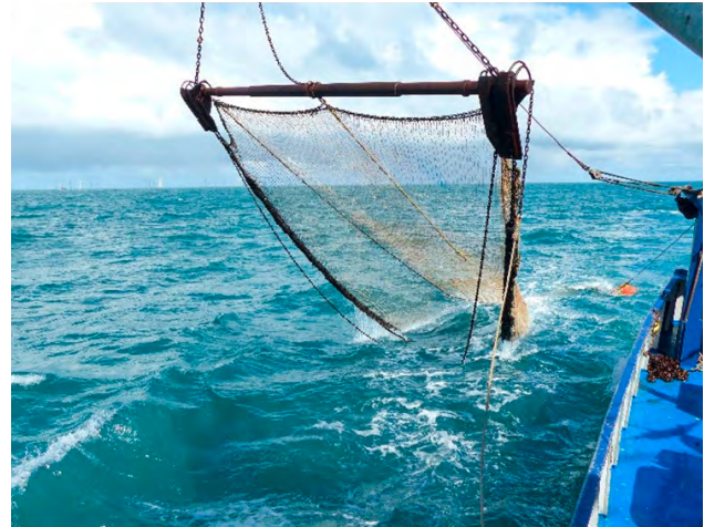
Abbildung 17: Standard-Fanggerät für die Fischerfassung nach StUK4: 7 m-Baumkurre am Steuerbordausleger eines für die Voruntersuchung des Schutzgutes Fische gecharterten Krabbenkutters (Foto: Dr. Andreas Dänhardt, BSH)
