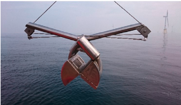
Abbildung 29: Standard-Fanggerät für die Erfassung der Infauna nach StUK4: van Veen-Greifer (Foto: Sebastian Fuhrmann, BSH)
