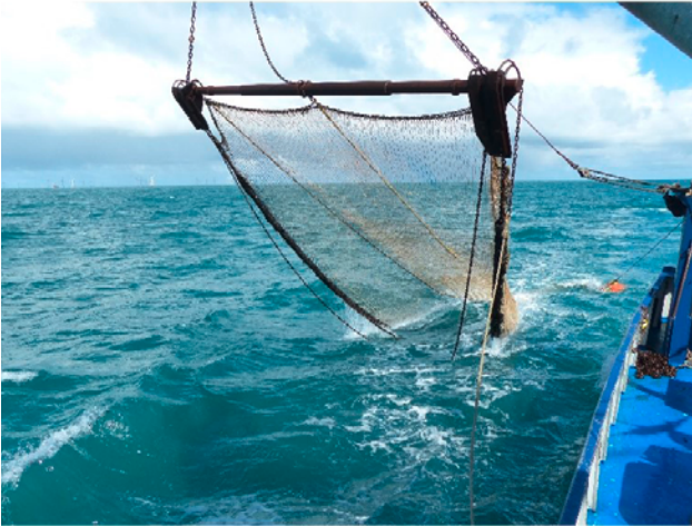
Abbildung 28: Standard-Fanggerät für die Fischerfassung nach StUK4: 7-m-Baumkurre am Steuerbordausleger eines für die Voruntersuchung des Schutzgutes Fische gecharterten Krabbenkutters (Foto: Dr. Andreas Dänhardt, BSH)
