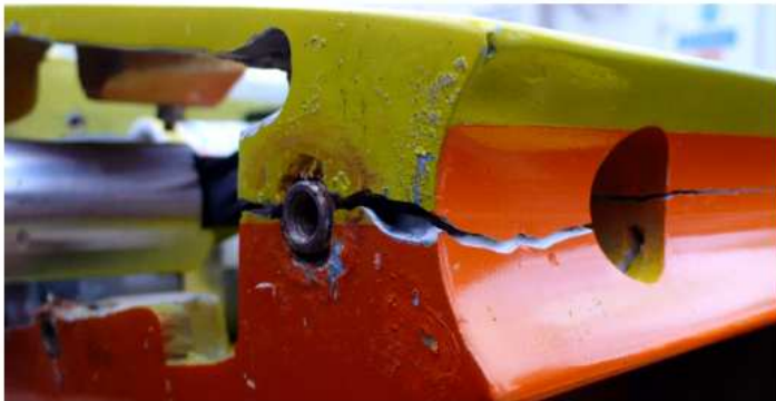
Schäden am ScanFish bei Inspektion am Ende der Reise.
