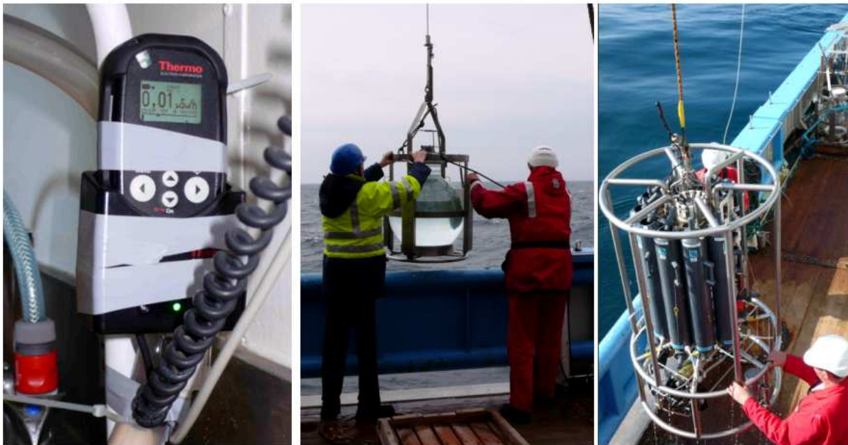
Links: RadEye-Strahlungsmesser im Wasserablauf der FerryBox. Mitte: 100-I-Glasschöpfer zur Bestimmung organischer Schadstoffe. Rechts: CTD Seabird SBE 911+ mit Kranwasserschöpfer.
