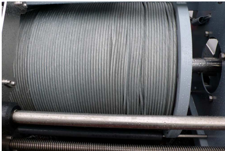
Die vom Werk unsauber aufgetrommelten Seillagen der KC-Winde.
