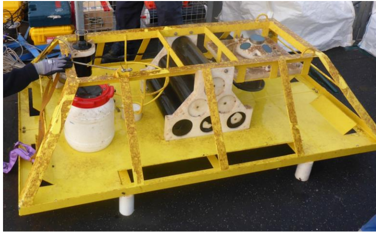
Abbildung 6: AWAC Absetz-Gestell (Eigenentwicklung IOW) für AWAC und Seegangsmesssysteme incl. hydroakustischem Evologics Modem sowie Releaser
