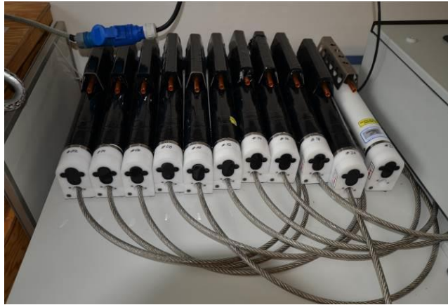
Abbildung 3: Induktive Messkette mit SeaBird SBE 37 IM (Temperatur, Leitfähigkeit und Druck)
