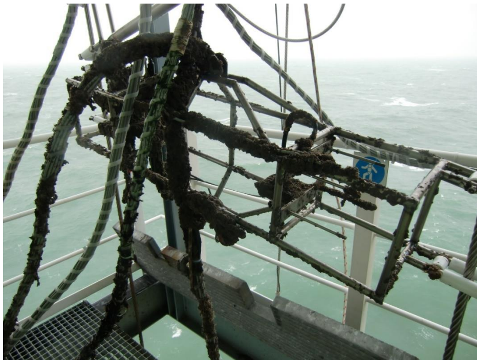
Abbildung 9: Bewuchs der Messkette und eines Schutzkorbes vor der Wartung.
