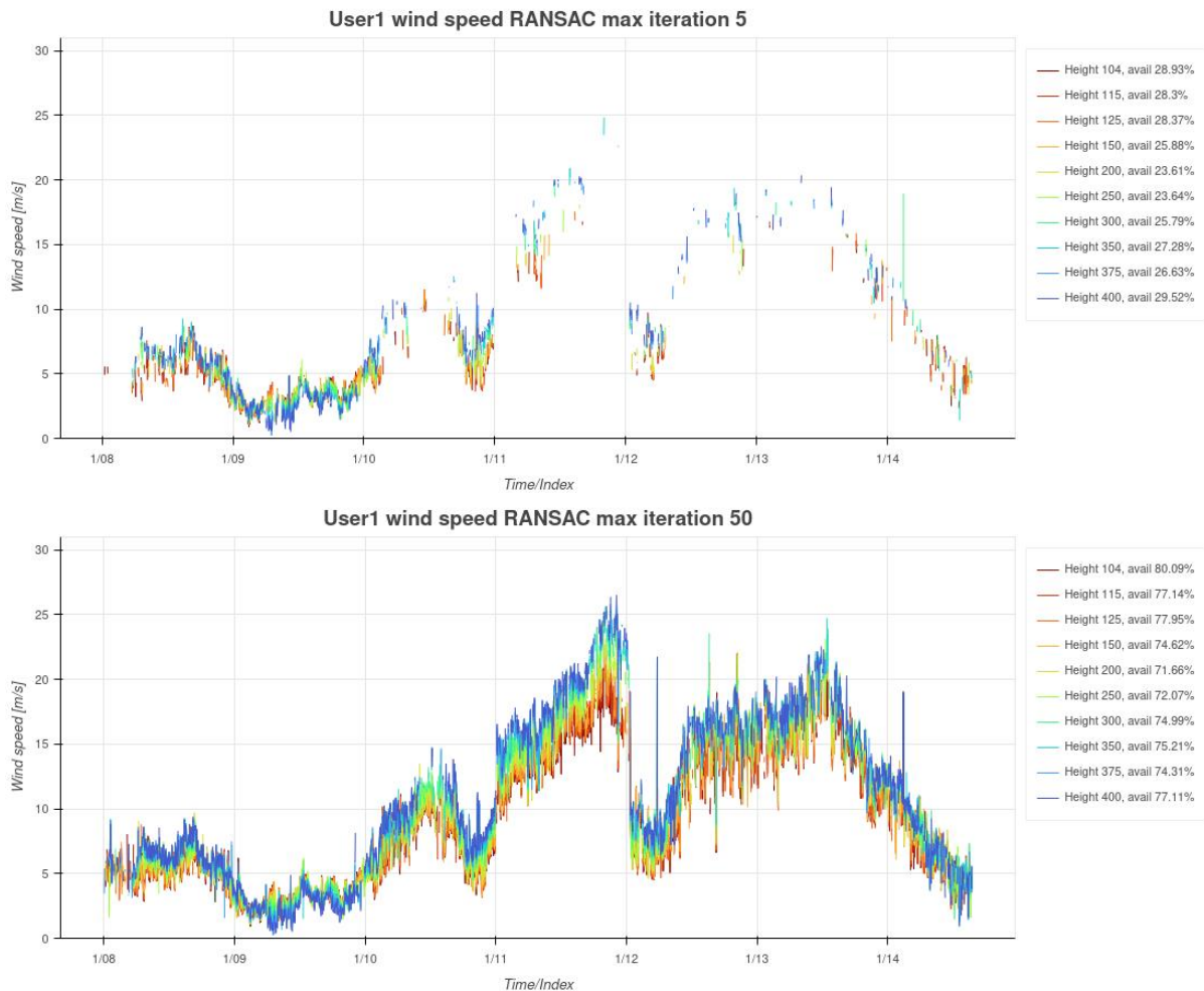
Abbildung 7-9: Zeitreihe der Windgeschwindigkeit, Meidanwert für 10 Wiederholungen, gefiltert nach der Standardabweichung der Wiederholungen für, Oben – 5 Iterationen, Unten – 50 Iterationen.
