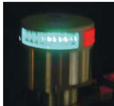
Prüfung von LED-Navigationslichtern im BSH
