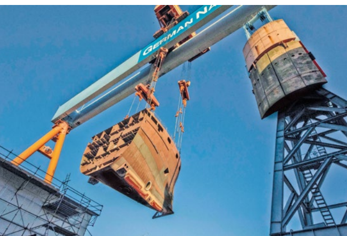
Der gefertigte Bug, das Vorderteil der ATAIR, wird mit dem Rumpf zusammengefügt
